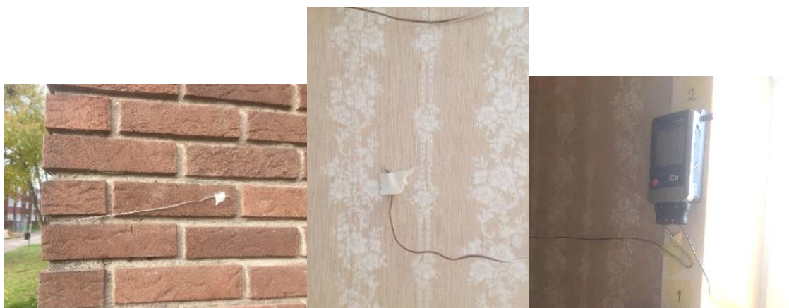
Figur 7: Bilder på givare för mätningar på ytterväggar, Finspång. Från vänster: termoelement på utvändiga ytor, termoelement på insidan. Dessa bilder visas även i ett konferensbidrag (Abdul Hamid m.fl. 2022).
