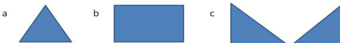
Figur 1: Principiellt utseende för de olika fördelningstyperna för indata, a: triangulär, b: likformig och c: skev triangulär (höger respektive vänsterskev, till ex. g-värdet av fönster samt SFP av ventilationssystem).
