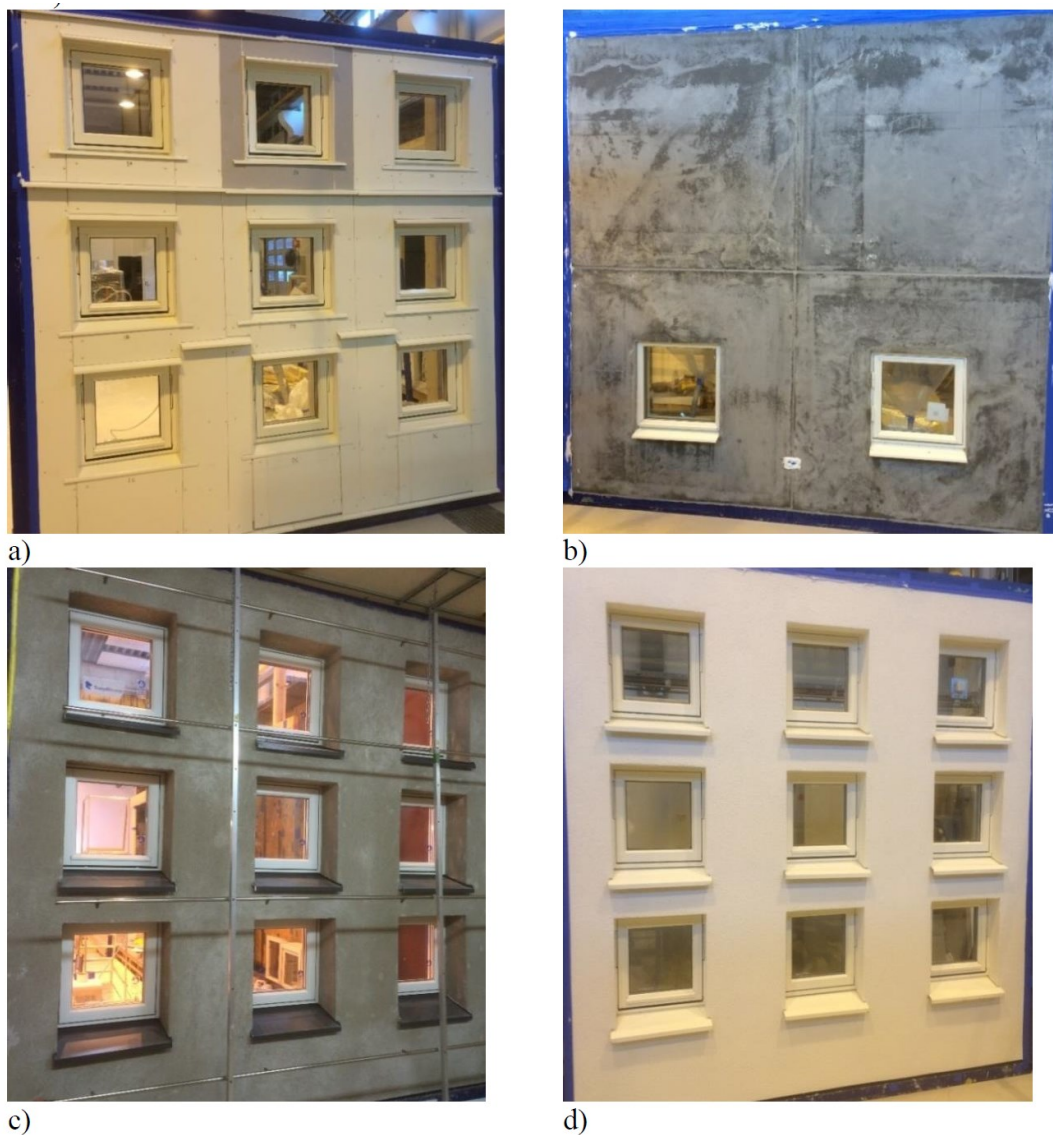
Figur 1. Foton av olika fasadsystem (a-d) som exponerats för slagregn i klimatkammare.
