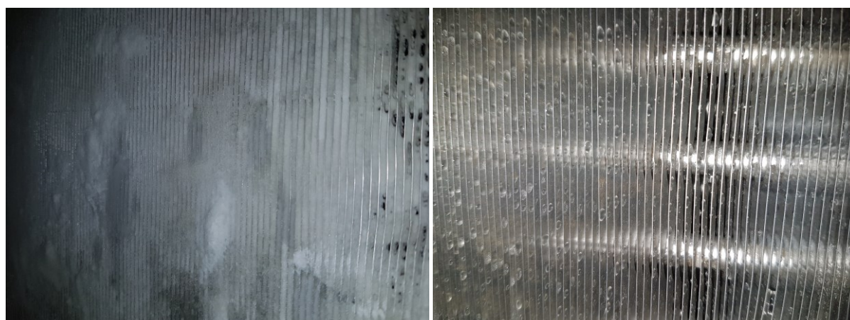
Figur 2.1: Bilder på sista steg i nedsmutsningsförsök med potatismjöl, före (vänster) och efter (höger) rengöring.
