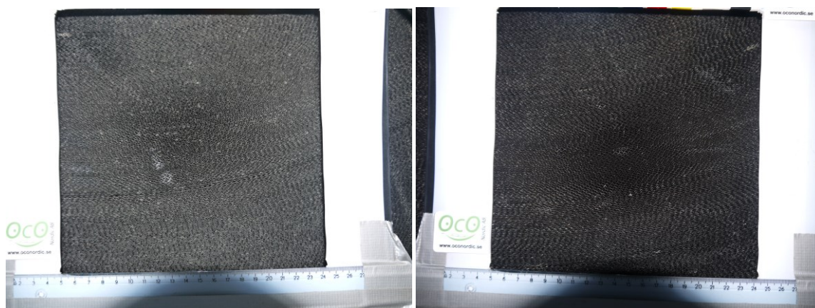
Figur 3.3: Bilder för åskådliggörande av skillnad före (vänster) och efter (höger) rengöring av aggregat. Uppmätt skillnad i temperaturverkningsgrad: 24%, tryckfall: 44 Pa.
