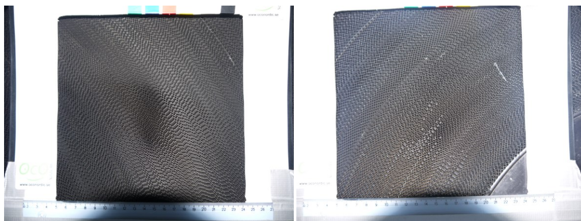
Figur 3.4: Bilder för åskådliggörande av skillnad före (vänster) och efter (höger) rengöring av aggregat. Uppmätt skillnad tryckfall: 11 Pa.
