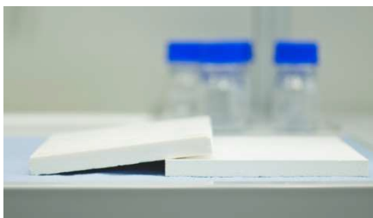
Figur 1: En skiva av organisk aerogel (polyuretan) (© BASF).
