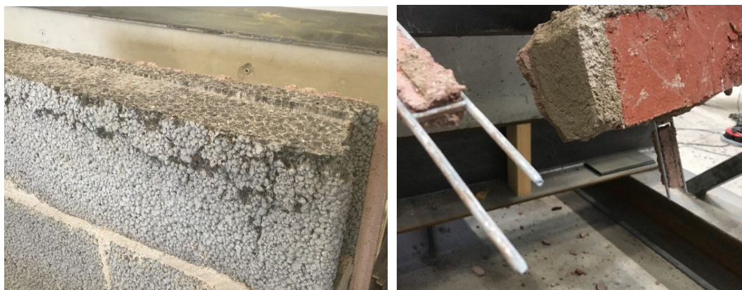
Figur 3 Prägling av väggens belastade kant (vänster); dragbrott i förstärkningen, med följd att väggen kollapsade (höger).
