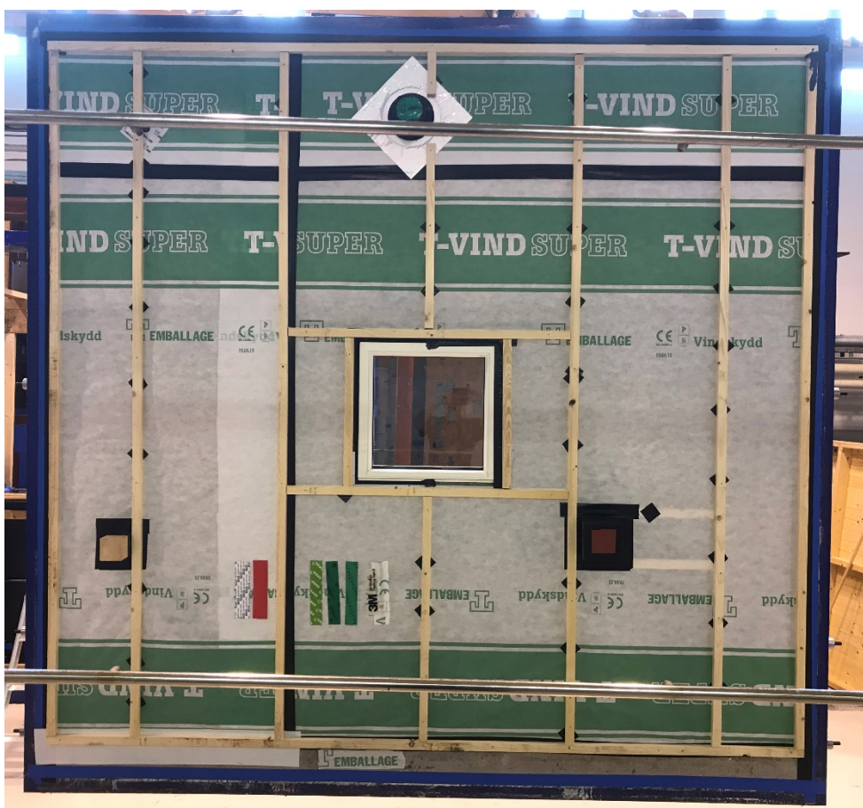
Bild 3. Provvägg klar för provning.
