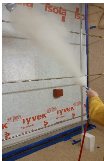
Bild 5. Konstgjort damm "sprutas" mot folien.
