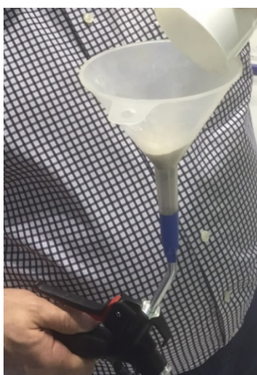
Bild 4. Tratt ansluten till tryckluftpistol och fylld med konstgjort damm.
