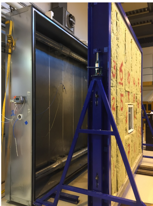
Bild 5. Provväggen på väg att anslutas till klimatkammaren för värmebehandling.
