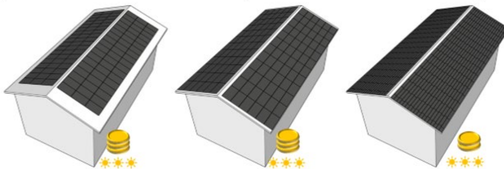
Figur 2 Utanpåliggande solcellsmoduler, integrerade solcellsmoduler och solcellstakpannor.
